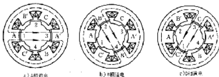
图 1-20 反应式步进电机结构原理图：
